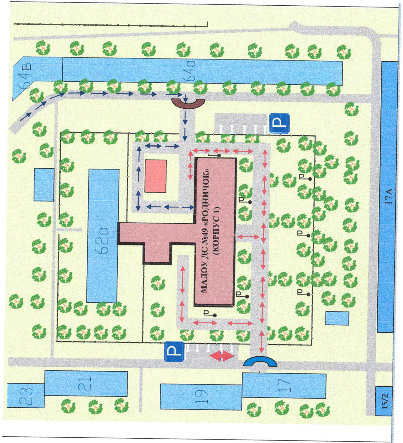
СХЕМА №4 ПУТИ ДВИЖЕНИЯ ТРАНСПОРТНЫХ СРЕДСТВ ПО ТЕРРИТОРИИ МАДОУ Г. НИЖНЕВАРТОВСКА ДС №49 (КОРПУС 1) К МЕСТАМ РАЗГРУЗКИ/ЛОГРУЗКИ И РЕКОМЕНДУЕМЫЕ БЕЗОПАСНЫЕ ПУТИ ПЕРЕДВИЖЕНИЯ ВОСПИТАННИКОВ
